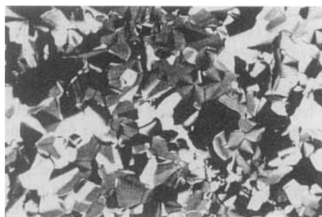
Abb. 1. Fächerförmige Textur der D_{hd} -Phase von Verbindung C1 bei 20 °C zwischen zwei gekreuzten Polarisatoren.
